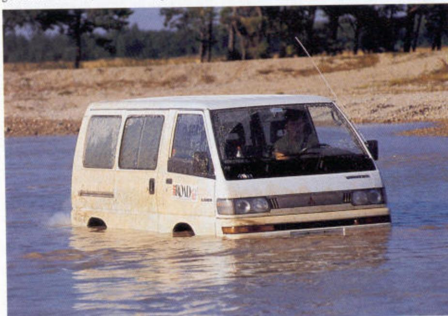
50 cm Wattiefe läßt Mitsubishi zu; wird es mehr, saugt das Getriebe durch die Entlüftung Wasser an
