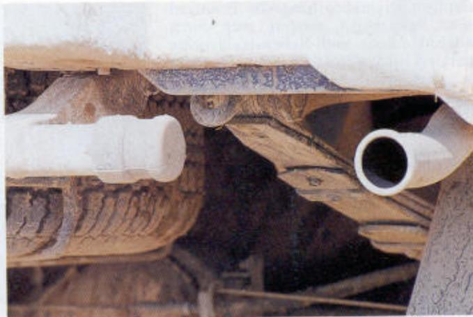
Das unter dem Hecküberhang montierte Ersatzrad schränkt den Böschungswinkel ein; der hintere Abschlepphaken ist hinreichend gut erreichbar
