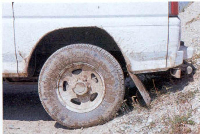
Der Hecküberhang ist kürzer, aber tiefer; so ergeben sich ebenfalls 28° Böschungswinkel, begrenzt durch Ersatzrad, Nebelschlußlicht und Auspuff
