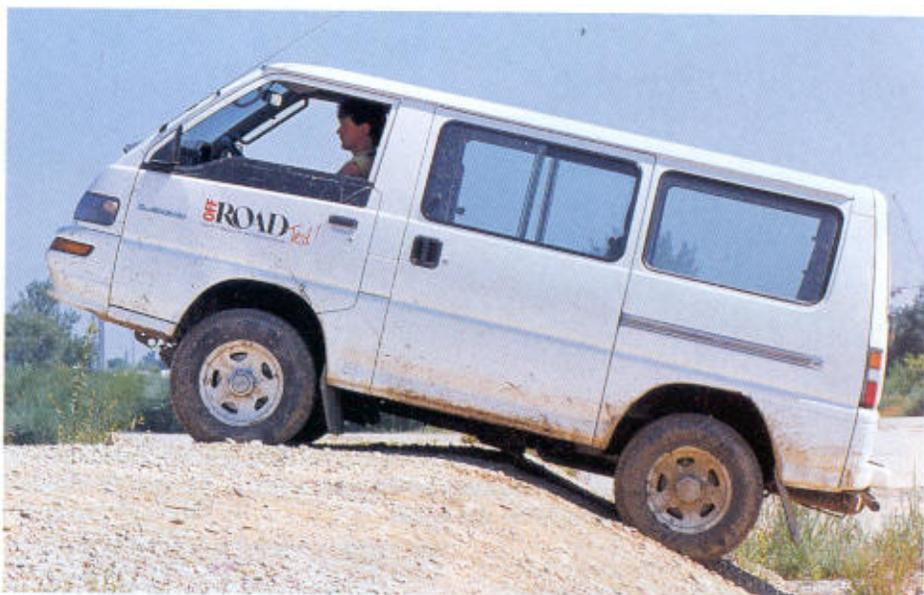
Der äußerst kurze Radstand von 2,24 m ergibt einen sehr ordentlichen Rampenwinkel von 30°
